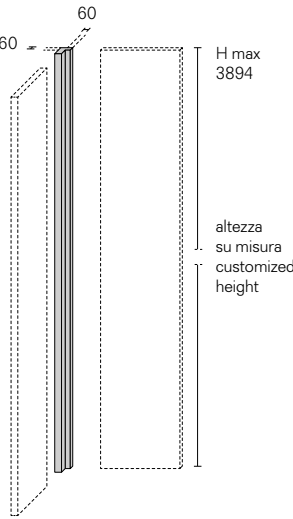
Montante angolare per pannelli ad angolo interno Corner upright for internal corner panels
