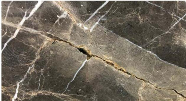
Lastra con fessure naturali livellate con resine | Slab with natural cracks filled with resin | Marmorplatte mit naturröhren Sprünge mit Harz geebnet | Dalle avec fissures naturelles comblées avec des resines | Losa con fisuras naturales niveladas con resinas
