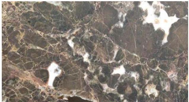
Lastra con stuccatura | Slab with filling | Dalle avec enduit | Platte mit geschlossenen Löchern | Placa con estucado
