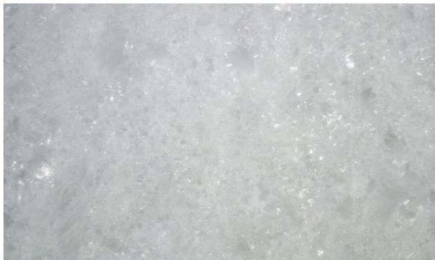
Inclusioni di quarzo | Quartz inclusions | Quarzeinschlüsse | Inclusions de quartz | Inclusiones de cuarzo
