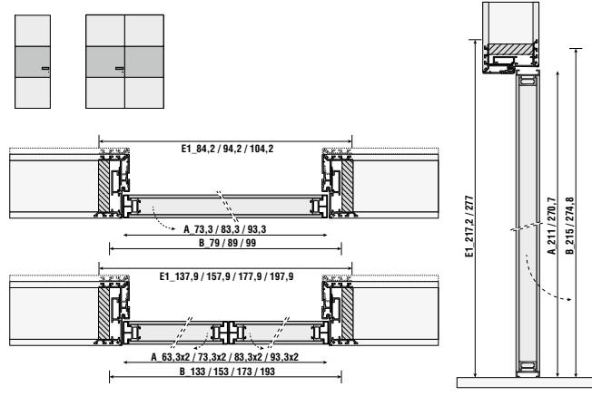
A\_Modulo / Panel - B\_Luce netta falsotelaio / Subframe measurement - E<sup>1</sup>\_Ingombro per riduzione spessore vano esterno / Dimensions for reducing the thickness of the external subframe
