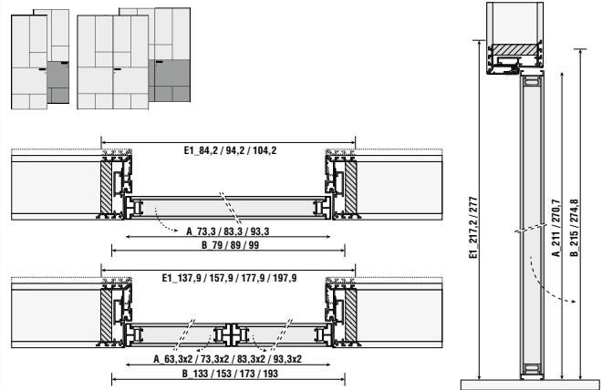
A\_Modulo / Panel - B\_Luce netta falsotelaio / Subframe measurement - E<sup>1</sup>\_Ingombro per riduzione spessore vano esterno / Dimensions for reducing the thickness of the external subframe
