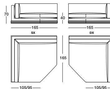
Elementi con piano di servizio / Units with utility shelf / Элементы со вспомогательной поверхностью
