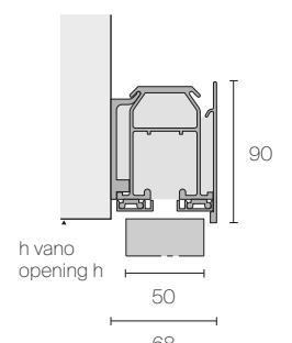
1. Binario di scorrimento con profilo telescopico di aggiustaggio brevettato. Consente la perfetta messa in bolla del binario di scorrimento e di compensare gli eventuali dislivelli del soffitto, senza fasce di tamponamento e spessori aggiuntivi. Dimensioni in lunghezza fino a 6000 mm.
